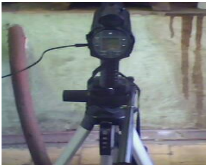
14 Сурет - Жану температурасын өлшейтін пирометр
